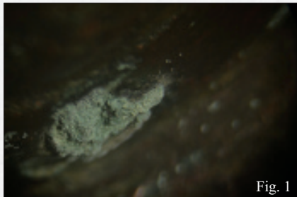
Figg. 1, 2. Particolari dei fenomeni ossidativi in corso su MO373 osservati con microscopio ottico.
